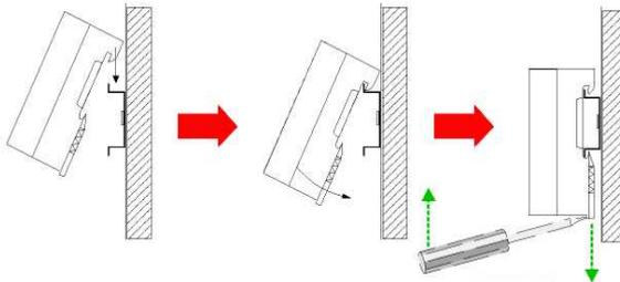
5. Опускайте (поворачивайте) модуль вниз пока он не будет зафиксирован на рейке и не щелкнет защелка.
