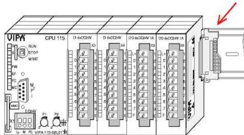
6. Каждый модуль расширения имеет шинный соединитель на 1 сегмент. Теперь вы подключаете в систему модули расширения, которые подключаете справа от процессорного модуля. Модули расширения могут быть System 100V или System 200V.
