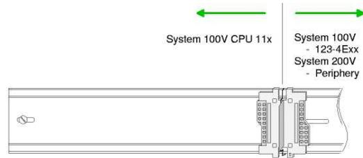
3. Установите в вашу System 100V CPU 11x с левой стороны шинного соединителя, зафиксируйте на рейке.
