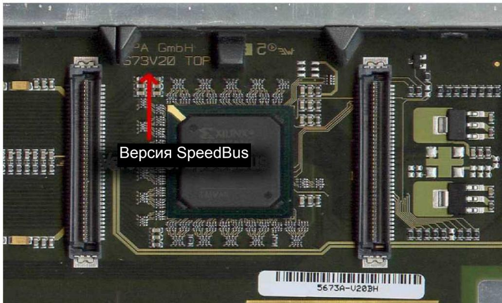
Speedbus версия шинной стойки
