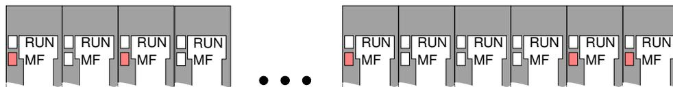
**Поведение:** После включения питания индикатор RUN каждого модуля гаснет, индикатор MF каждого модуля спорадически загорается.
